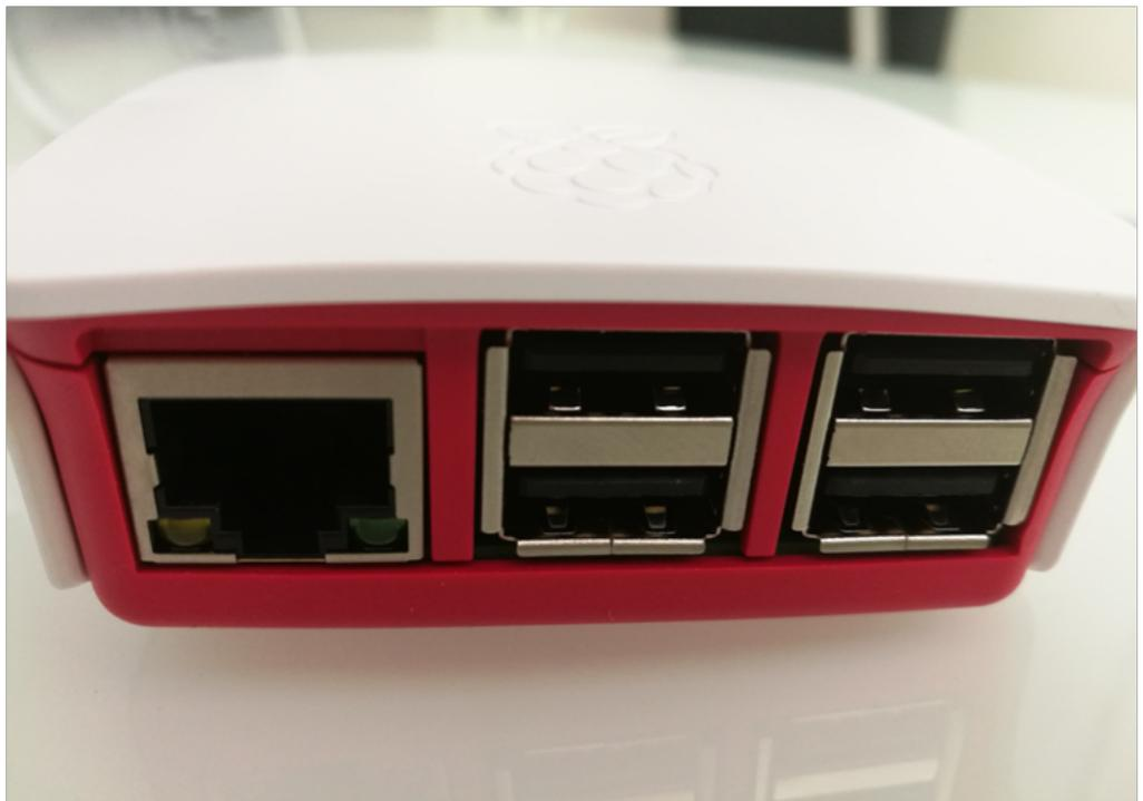
En la entrada de ethernet, introduciremos el cable de red en primer lugar. Podemos utilizar el que se provee en el kit o bien utilizar uno propio. La precaución que se debe tener es que al conexión debe estar configurada como DHCP, para que obtenga la ip de forma automática.
