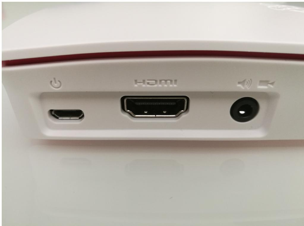
Cuando hayamos conectado el HDMI podremos ya conectar en la hembra de la izquierda de la imagen el adaptador de corriente. La salida de micro que aparece en la imagen se queda sin conectar.
